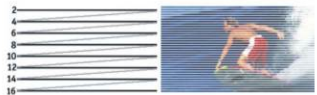
Affichage des trames paires d'une image lors du 1/50 de seconde suivant
