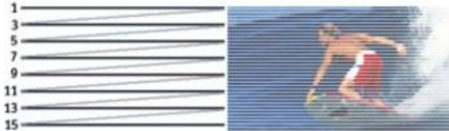
Affichage des trames impaires d'une image lors d'un premier 1/50 de seconde
